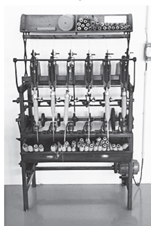
Caneleira para tear C45 Auto Mecânica da Beira Lda, Castelo Branco (Dorindo Ribeiro, Cebolais de Cima)
