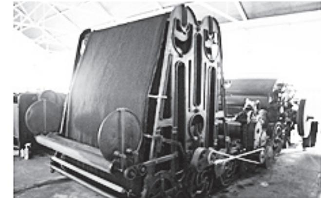
No processo seguinte o operário corta a manta horizontalmente e encaminha-a para ser enrolada num cilindro de madeira que a transfere para a 3<sup>a</sup>. Carda.
