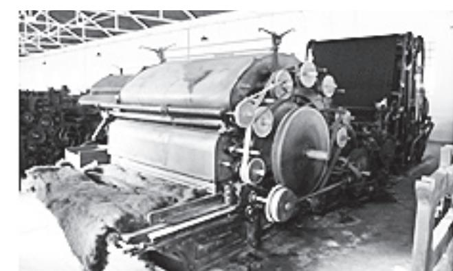
Nesta 2<sup>a</sup>. Carda as diversas mantas obtidas na operação anterior vão ganhando tensão e na parte final da carda, na "cantareira", as mantas já uniformizadas vão sobrepor-se para atingir a densidade desejada.
