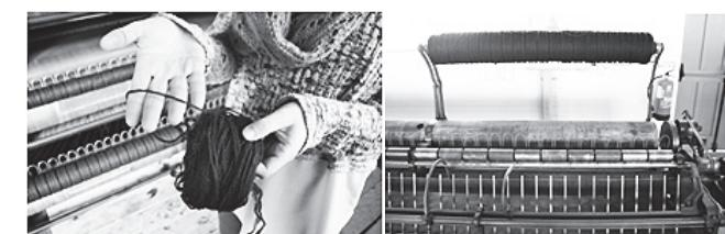
9. Na "Fiação" e com o movimento de vai e vem desta e a rotação dos fusos, o fio é esticado e torcido por a ganhar a consistência pretendida e necessária a que, ao ser tecido no tear, saia a "fazenda"/tecido pretendido.
