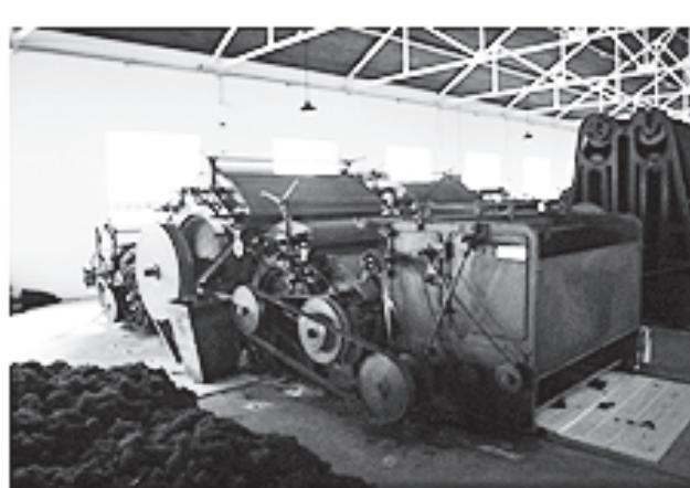
5. 2<sup>a</sup>. Carda – como da segunda carga se pretende que saia uma manta com uma textura (peso) adequado ao fio final que se busca, ao carregar a manta/véu na sua passadeira o operário tem que providenciar que cada carregamento de manta tenha a textura necessária para que na saída se obtenha a mecha pretendida; socorre-se para isso duma balança romana que tem a seu lado, onde testa o peso da junção de mantas necessárias à textura pretendida;
